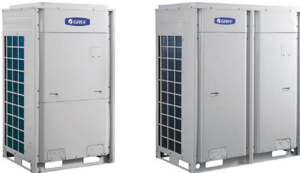
Beim Gree GMV5 Multi System können je nach Außengerätesystem bis zu 110 verschiedene GMV Innengeräte angeschlossen werden. Sie eignen sich daher besonders für größere Gebäude, bei denen nur ein Außengerät installiert werden soll. Die GMV5 Außengeräte zeichnen sich durch die neueste DC Invertersteuerung und leistungsstarke Gree DC Inverter Scroll Kompressoren aus.
